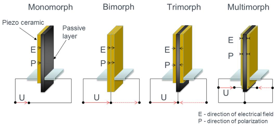
Normalerweise wird eine einseitige Einspannung gewählt, um die Auslenkung und Stellkraft am anderen Ende des Biegewandlers zu nutzen. Die Keramiksichten werden elektrisch angesteuert. Aufgrund des inversen piezoelektrischen Effektes entsteht eine mechanische Spannung, die eine Biegung des Verbundes erzeugt.
